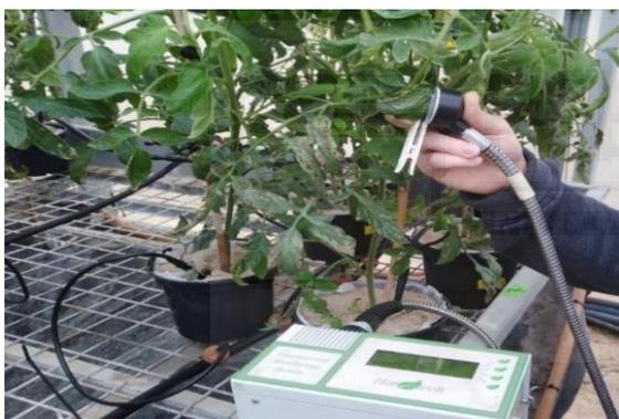
**Imagen 4.1** Medición de fluorescencia en clorofilas con Fluorímetro portátil de pulso modulado FMS-2.
