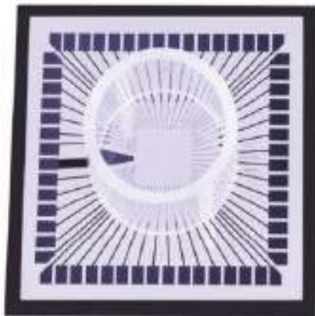
Figura 7. Imagen de la placa de electrodos. Figura 8. Disposición de los electrodos sobre el microchip óptico de campo de visión.
