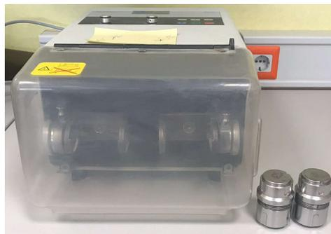
**Figura 7.** Molino mezclador de bolas Retsch MM 301.
