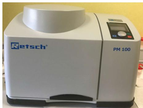
**Figura 8.** Molino planetario Retsch PM 100.
