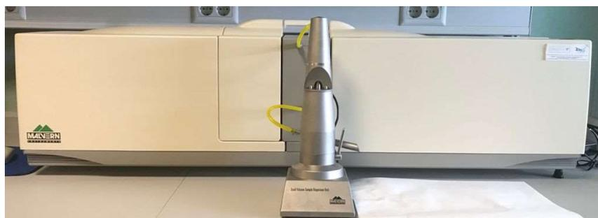
**Figura 12.** Difractómetro láser MASTERIZER 2000 modelo APA2000 de MALVERN INSTRUMENTS (LTD).
