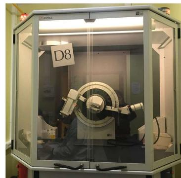
**Figura 11.** Principio de funcionamiento de un difractómetro (izquierda) y difractómetro de rayos X D8 ADVANCE, BRUKER AXS (derecha).
