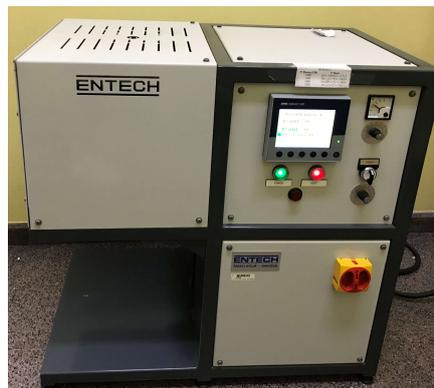
**Figura 6.** Horno ENTECH utilizado en los tratamientos térmicos.
