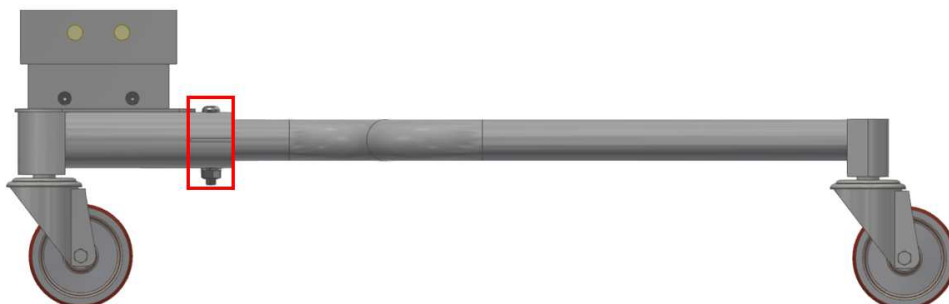
Figura 5.15: Unión base tubos ruedas posteriores.
