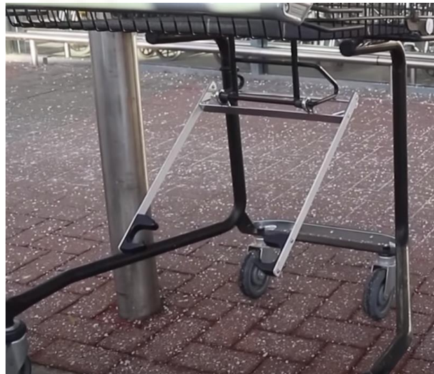
Figura 5.20: Sistema de anclaje silla de ruedas.
