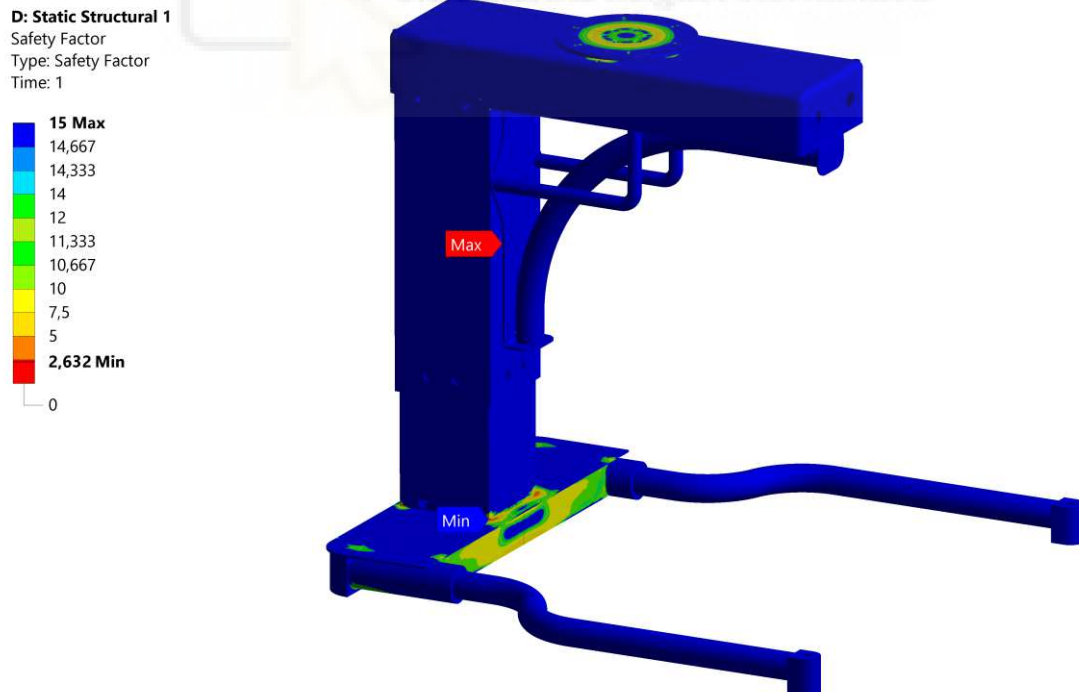
Figura 6.34: Coeficiente de seguridad. Altura máxima (E).
