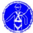
Protección individual obligatoria contra caídas
