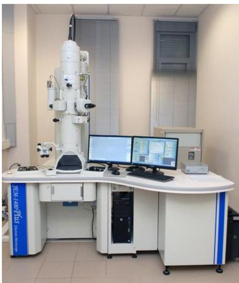
**Figura 3.5.** Microscopio de transmisión electrónica. Imagen obtenida de la web, <https://ssti.ua.es/es/instrumentacion-cientifica/unidad-de-microscopia/microscopia-electronica-de-transmision.html> consultada el 13 de mayo de 2019.
