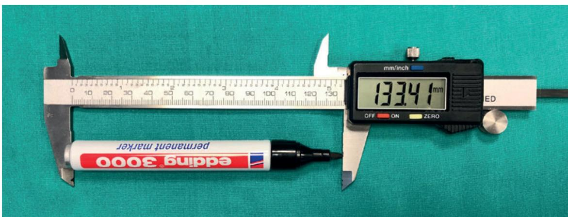
Foto 4.3 | Medida de la longitud del rotulador Edding 3000 nuevo, mediante pie de rey.
