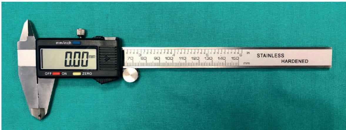
Foto 4.2 | Pie de rey analógico y digital, empleado para medir la longitud de los diferentes rotuladores.
