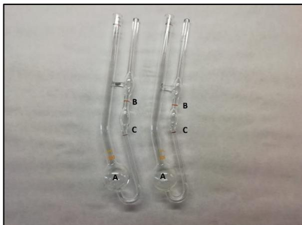
**Figura 10:** Viscosímetro Cannon Fenske V300 (izquierda) y Viscosímetro V400 (derecha).
