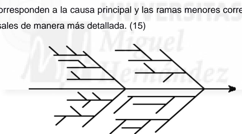
Ilustración 2. Esquema de un diagrama de causa y efecto
