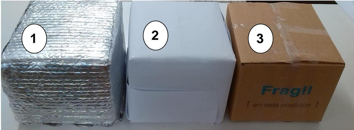
Ilustración 16. Embalajes con protecciones frente a la transmisión de calor
