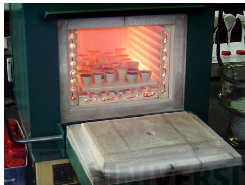
Figura 3.10 Calcinación de las muestras en la mufla a 582 °C
