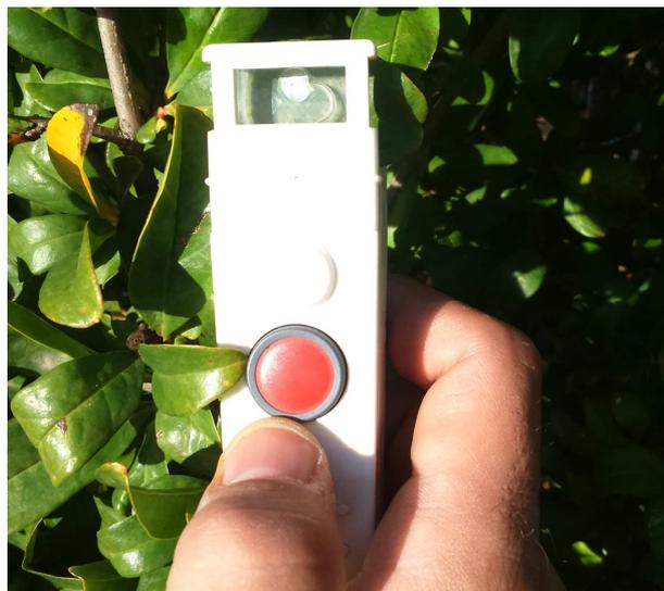
**Figura 23.** Pinza del porómetro en proceso de medición
