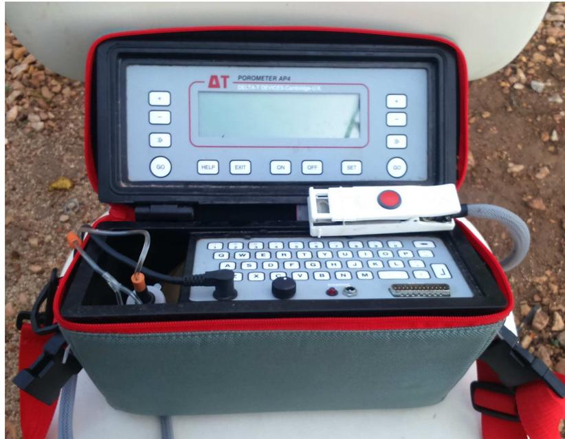
**Figura 22.** Porómetro empleado en el ensayo para medir la conductancia estomática.
