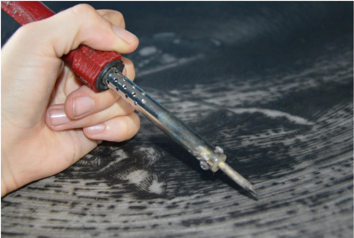
Fig. 9. Rayado del arraglás con soldador eléctrico.
