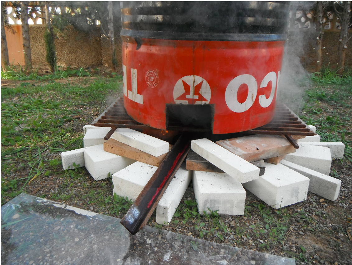
Figura 9: Horno de descerado casero
