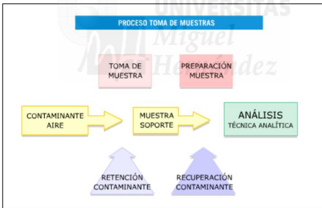
Esquema 1. Proceso de toma de muestras por un tubo, procedimiento de tubo adsorbente
