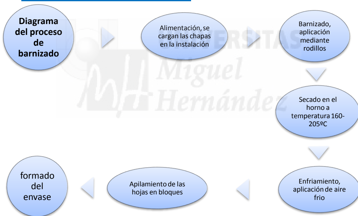
Esquema 2. Diagrama del proceso de barnizado
