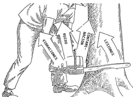
Figura 31. Máquina y herramientas de motor que exponen al trabajador a muchos riesgos
