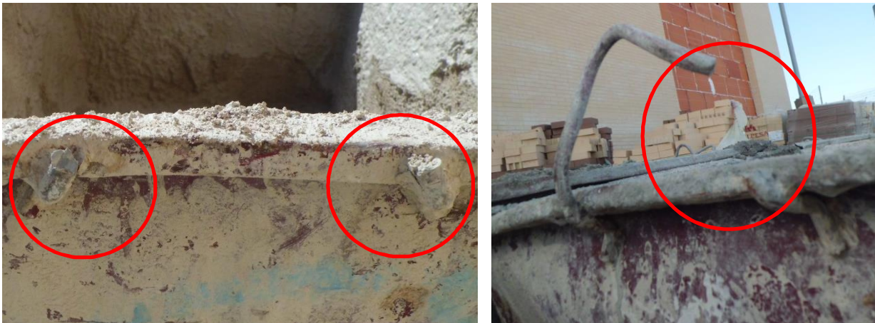
Ejemplo de 2 cubas con las asas rotas
