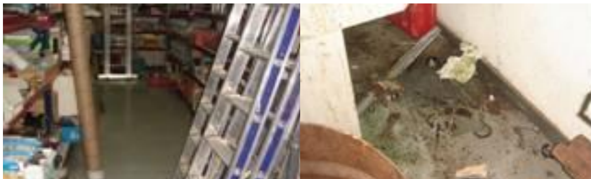
Figura 11. Desorden en el material entrañando riesgo de accidente y falta de limpieza en las instalaciones.
