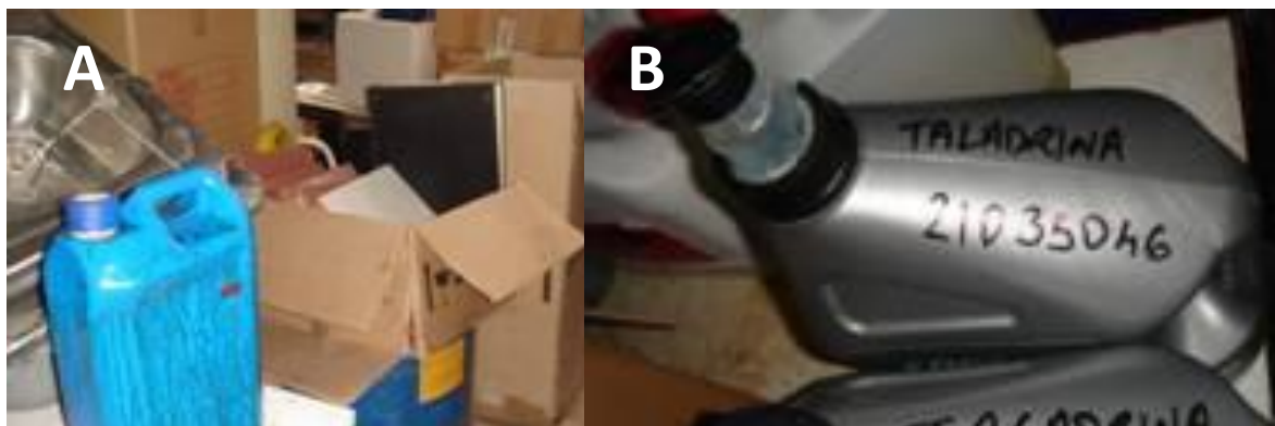
Figura 14. A) Posibilidad de derrames y vertidos. B) Lugar de almacenaje y etiquetado incorrecto.
