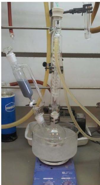
**Figura 13.** Montaje de la reacción con el embudo de adición de presión compensada en el laboratorio.
