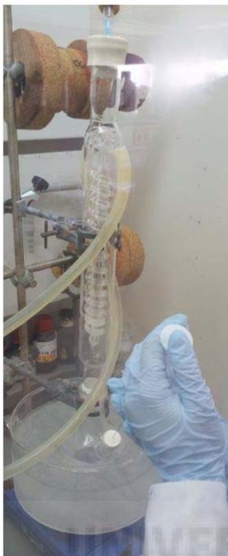
**Figura 12.** Adición del THF seco en el laboratorio.
