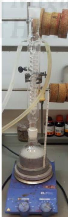
**Figura 8.** Reacción con sistema de reflujo en el laboratorio.
