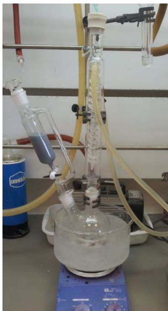
Figura 14. Montaje de la reacción con el embudo de adición de presión compensada.
