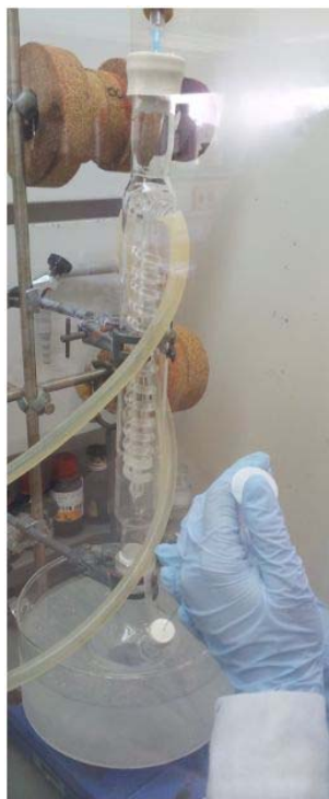
Figura 13. Adición de THF seco al matraz con hidruro de litio y aluminio.
