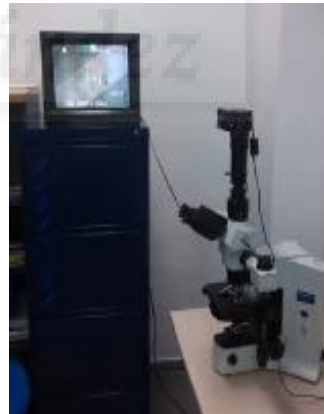
Figura 11.- Microscopio óptico acoplado a una cámara digital y a una televisión.
