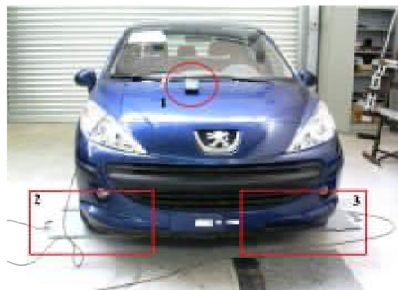
Figura 4.3 Esquema de situación de los instrumentos: 1 Display; 2 y 3 mantas de pesaje.
