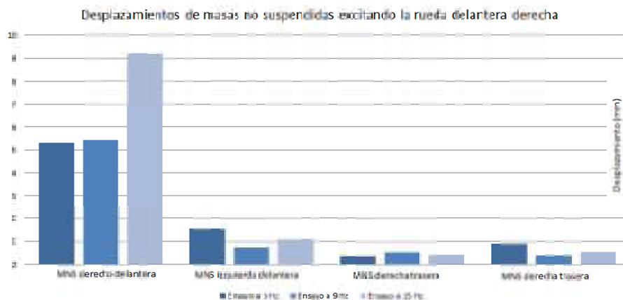
Figura 6.17. Desplazamientos de masas no suspendidas, a 3, 9 y 15 Hz. Ensayo A, excitando rueda derecha.
