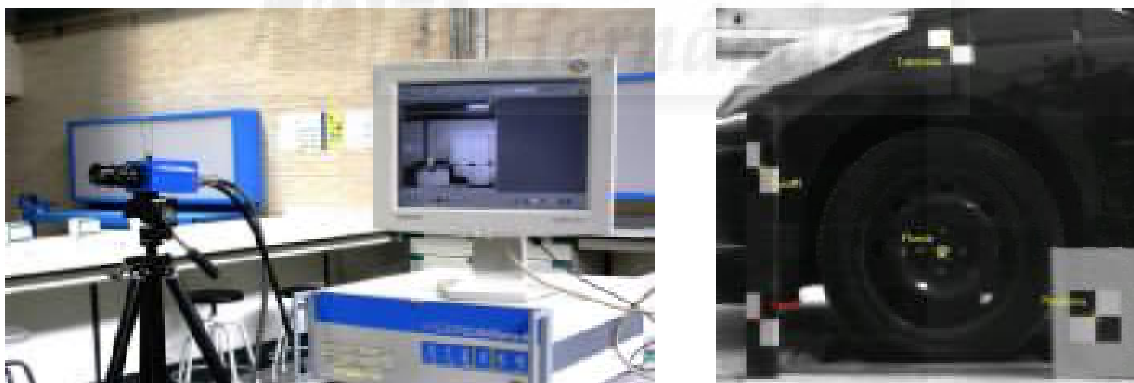
Figura 4.4 Equipo de grabación de alta velocidad e imagen del software TEMA empleado.
