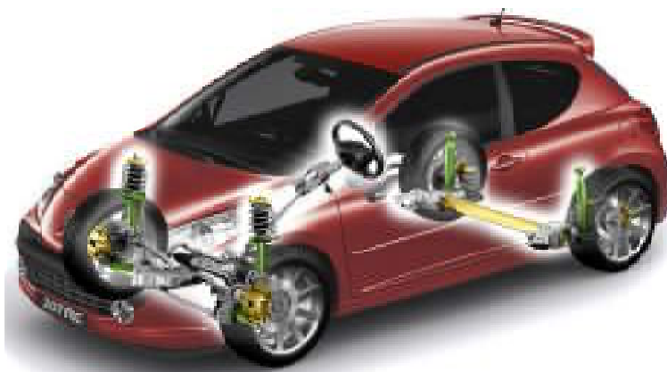
Figura 2.21. Utilitario Peugeot 207 con detalle de suspensiones.
