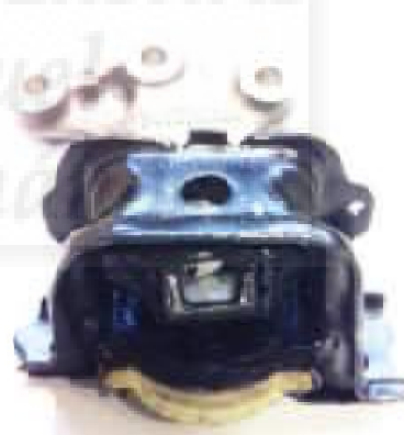
Figura 6.10. Soporte de motor deteriorado
