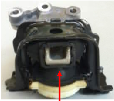
Depósito de fluido hidráulico
