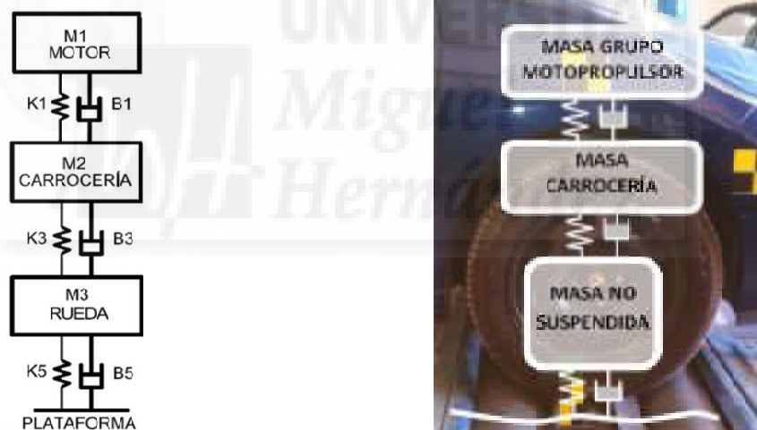
Figura 5.38. Modelo de 3 GDL con excitación simultánea de ambas ruedas equivalente al de 3 GDL
