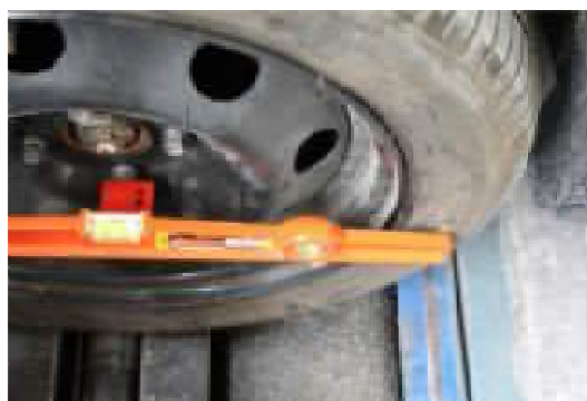
Figura 6.6. Nivelación de la plataforma de la masa no suspendida.
