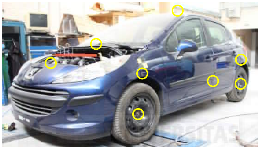
Figura 6.4. Ejemplos de puntos donde se ha medido la cinemática vertical del vehículo ante oscilaciones forzadas
