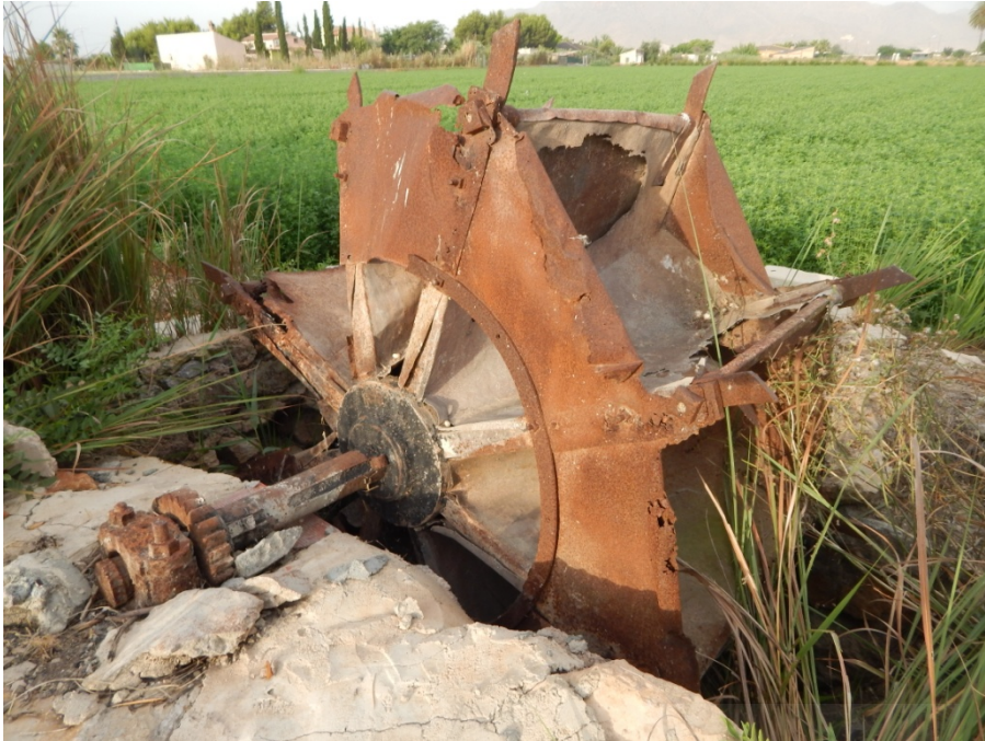
Foto nº 14. Sistema de riego. “Ceña a pie”, artesanal. Anclada en la acequia, un hombre andando sobre ella la hace girar elevando el agua hasta el nivel de la tierra.
