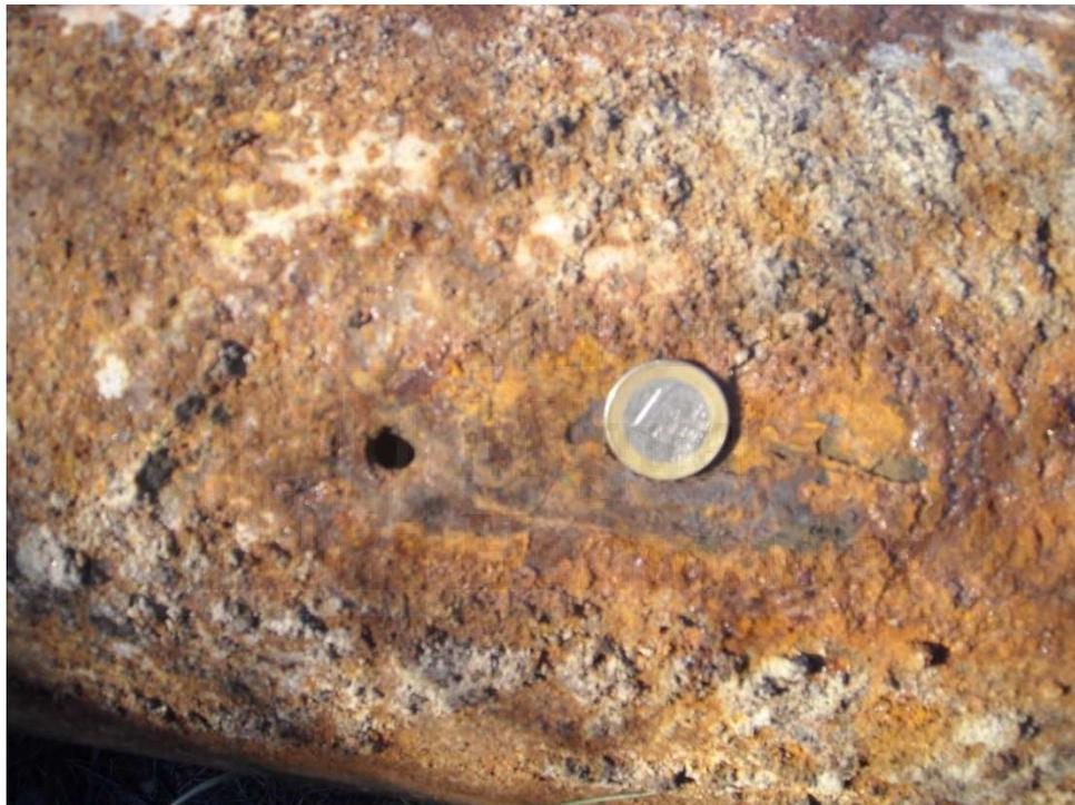
Figura 62. Perforación en la columna de impulsión en la instalación P.1.7.
