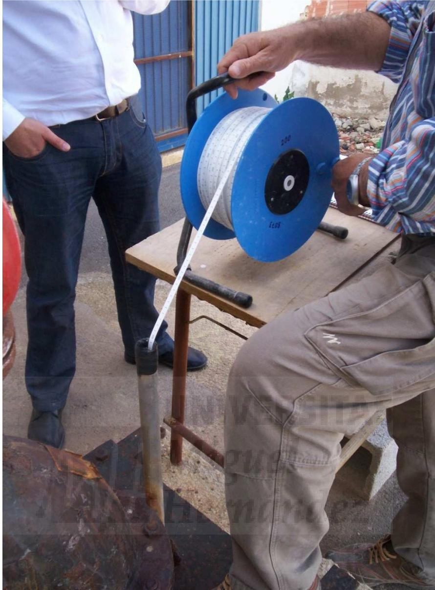
Figura 50. Medida manual de nivel dinámico mediante un piezómetro.
