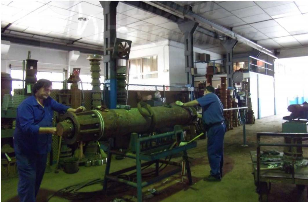
**Figura 12. Grupo de pozo en el taller para realizarle una transformación en la parte hidráulica para ajustarse a las exigencias energéticas reales del sondeo**
