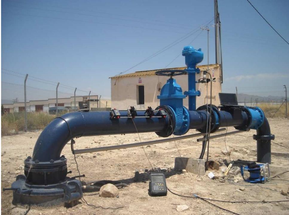
**Figura 49. Toma de datos hidráulicos con caudalímetro ultrasónico y sonda de presión junto con PC para descarga de datos.**
