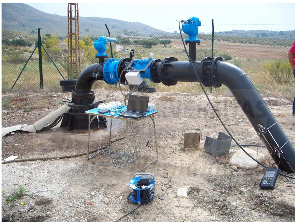
Instalación P.1.7. (Chopo), durante la toma de datos hidráulicos mediante el caudalímetro ultrasónico y sonda de presión
