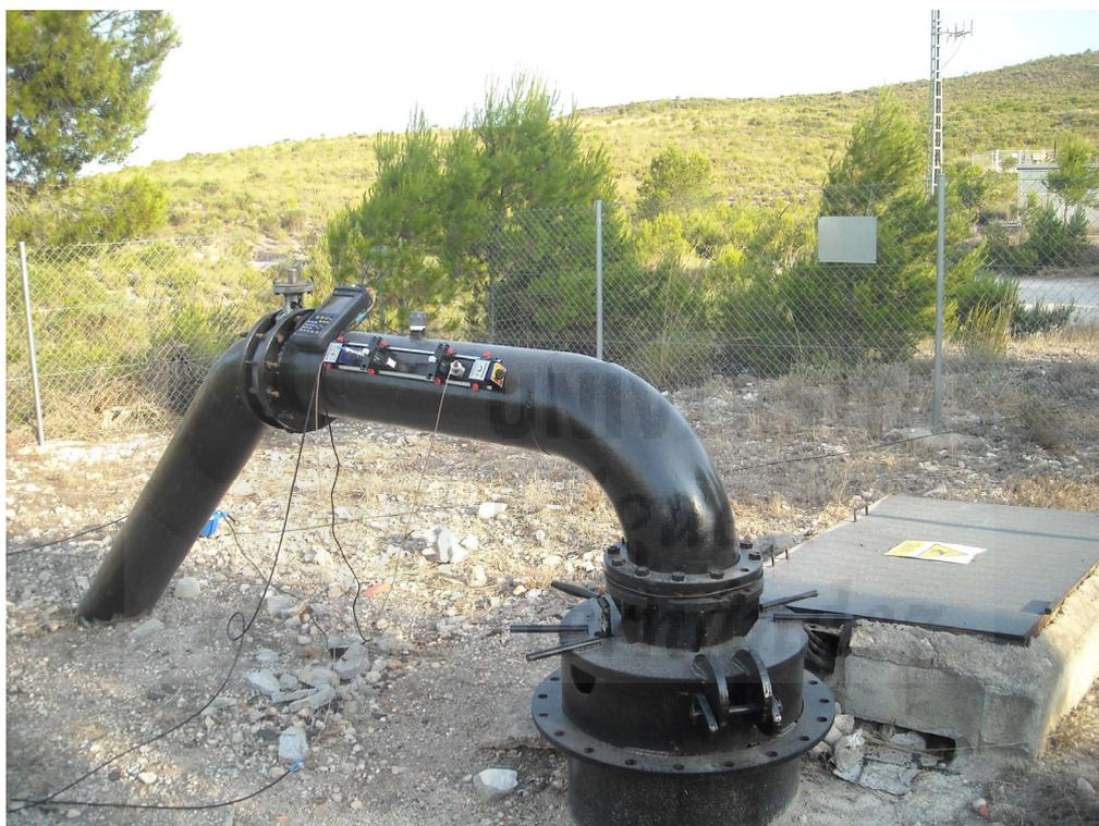
Instalación P.1.4. (La Hoya I), tomando datos de caudal mediante el caudalímetro ultrasónico
