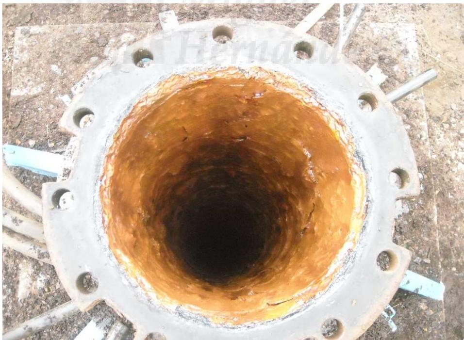
**Figura 36. Estado de la superficie interna de una columna de impulsión de un sondeo**
