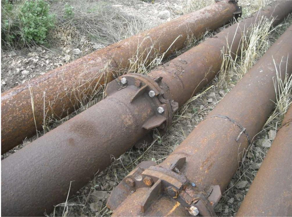
**Figura 58. Detalle de las bridas con hendiduras para el paso del cableado que unen los tramos de la columna de impulsión**
