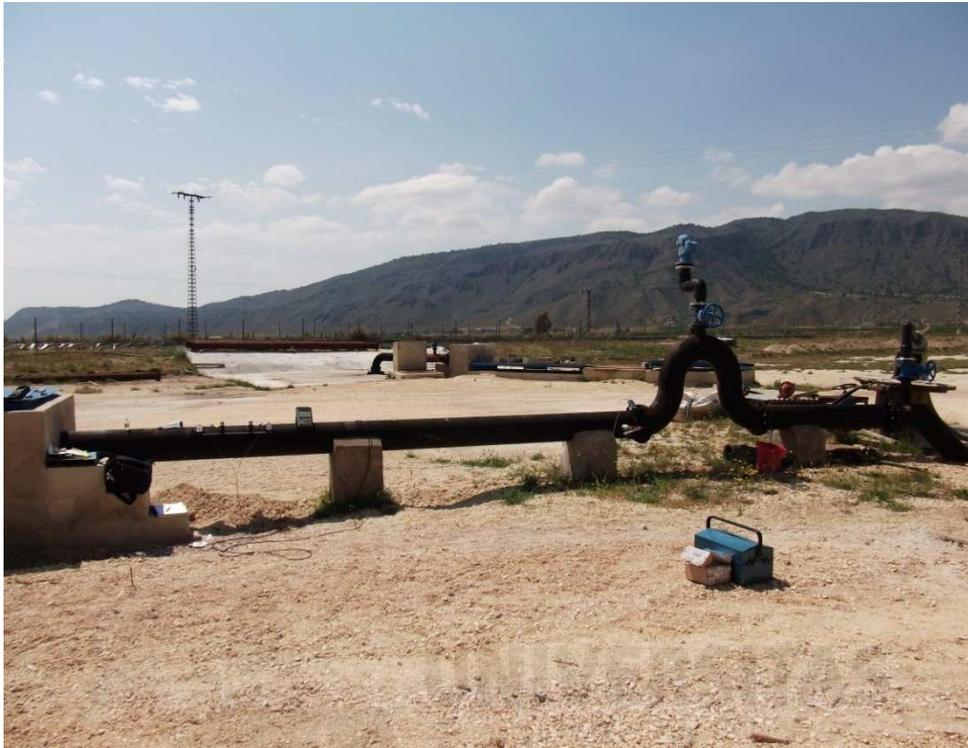
**Figura 54. Registro de parámetros hidráulicos tras el mantenimiento preventivo realizado en el pozo empleado para validar el modelo propuesto**
