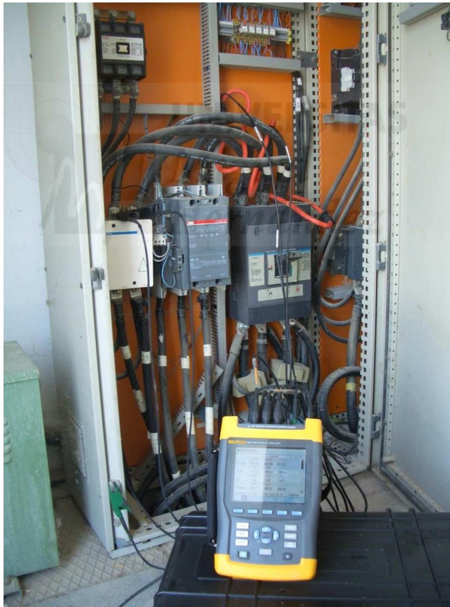
**Figura 48. Analizador de redes eléctricas registrando y almacenando datos.**
