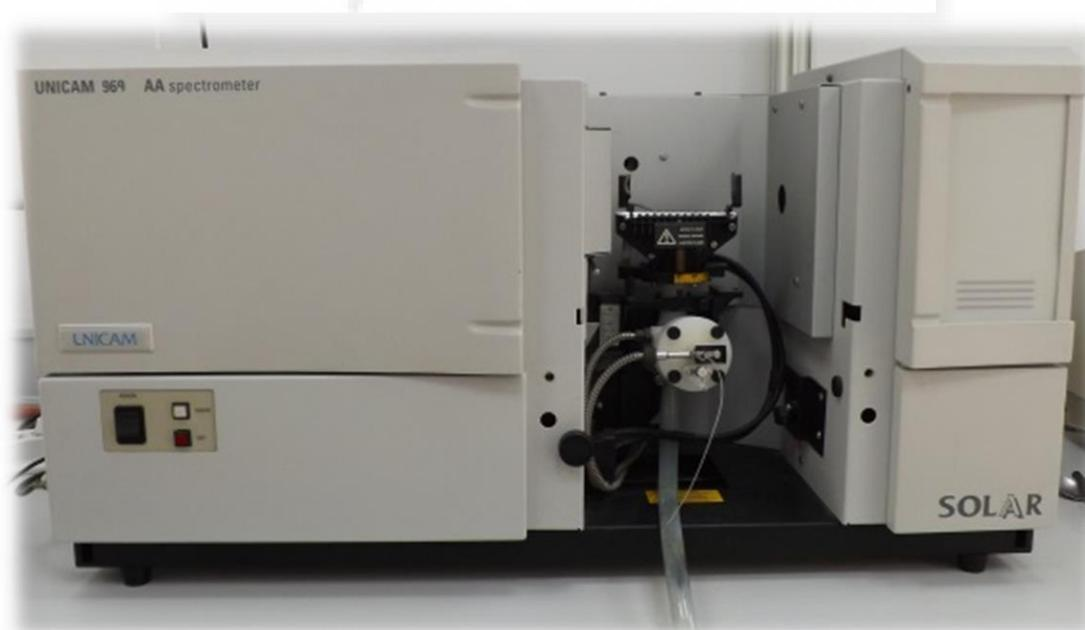
**FIGURA 14.** ESPECTRÓMETRO EMISIÓN-ABSORCIÓN ATÓMICA UNICAM SOLAAR 969.
