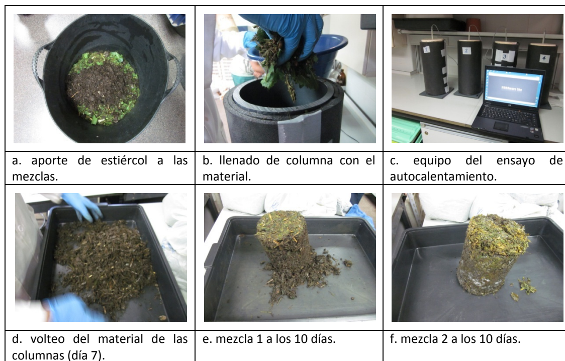
Figura 3.6. Primer ensayo de autocalentamiento de las mezclas 1 y 2 con 20% estiércol vacuno.
