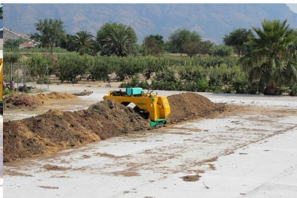
**Figura 3.5.** Mezclado/volteado de pila.
