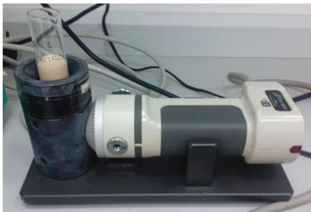
Figura 19: Colorímetro Minolta realizando determinaciones de la masa
