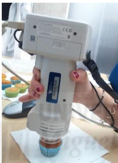
Figura 23: Espectrofotómetro Minolta Camera CM 700 D
