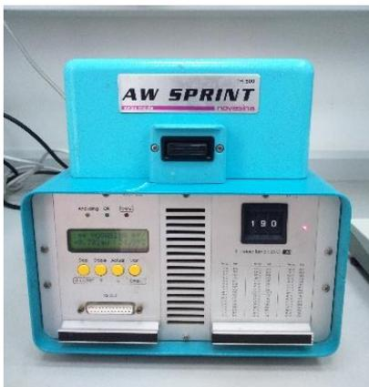
Figura 26: Higrómetro Novasina para la determinación de  $A_w$
