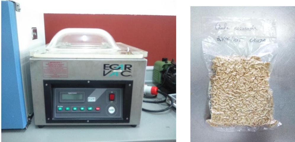
Figura 11: Izq. envasadora a vacío EGARVAC. Drcha. Coproducto envasado al vacío
