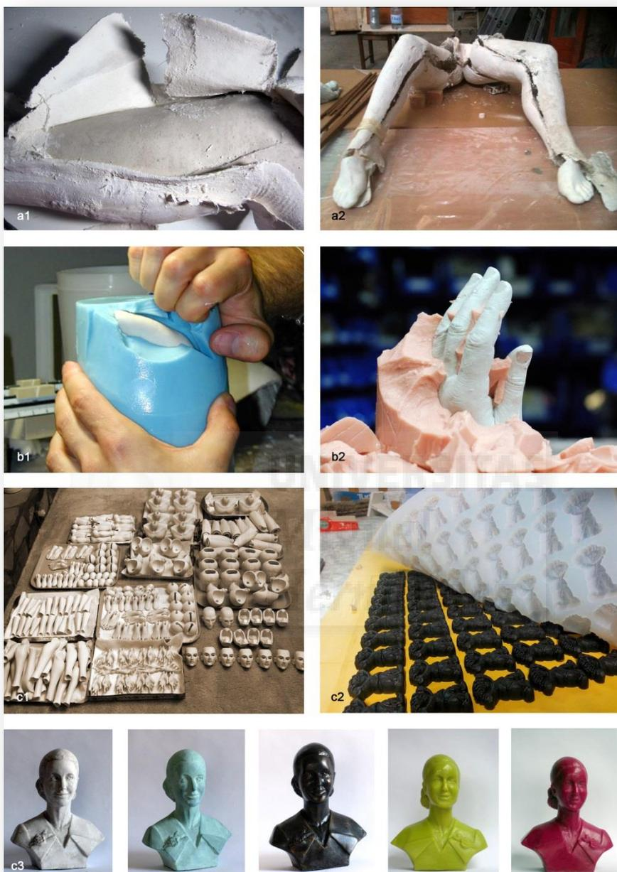
**Ilustración 84.** En la imagen podemos observar diversos moldes desechables, tanto rígidos (a1 y a2) como flexibles (b1 y b2), y a la vez reutilizables (c1 y c2) que posibilitan obtener multitud de reproducciones en un mismo material o en diferentes (c3).
