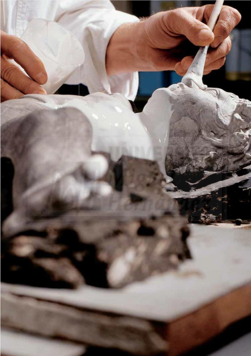
**Ilustración 45.** En la imagen se puede observar el instante perteneciente a la acción de moldeado; en este caso el modelo es cubierto parcialmente por silicona líquida aplicada por estampado mediante una brocha de punta flexible.
