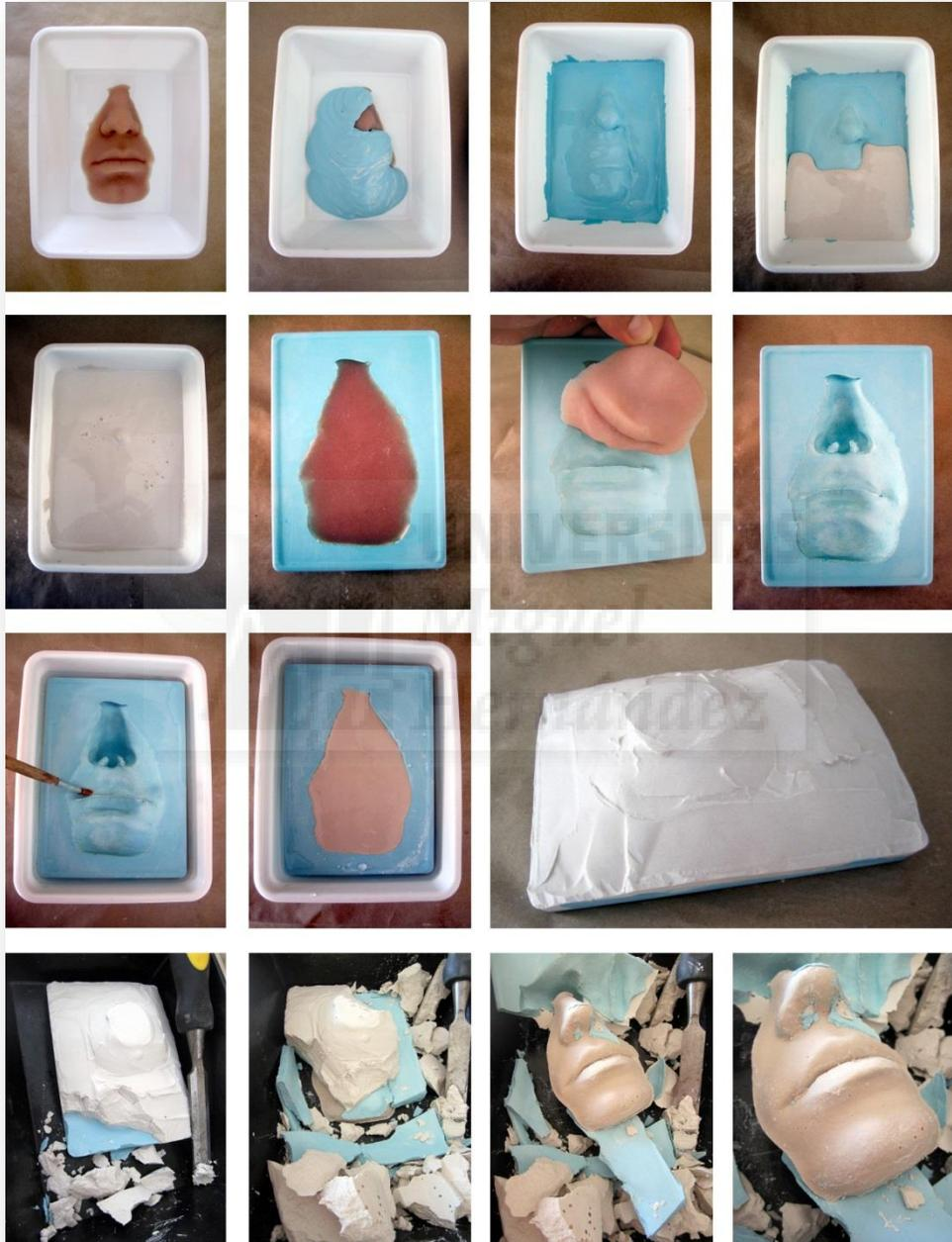
Ilustración 97. Molde desechable rígido de un fragmento por caja.
