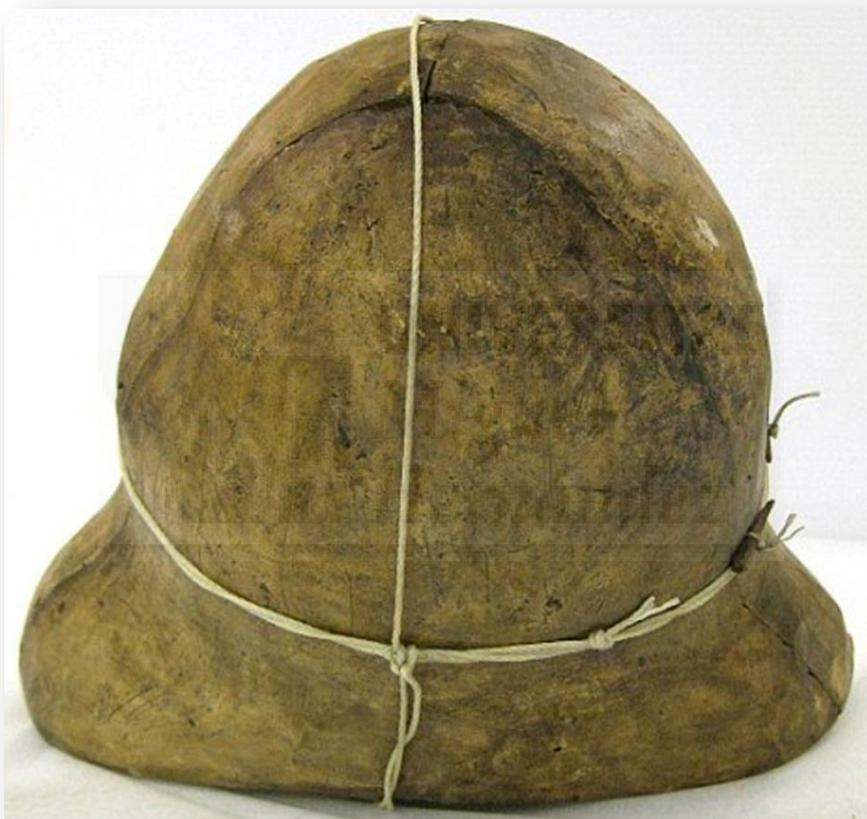
**Ilustración 10.** Molde *piezado* en yeso en donde se puede observar una línea de junta entre piezas mucho más precisa que en los anteriores moldes, también es destacable la cuerda y los topes de madera para la unión de las distintas piezas.
