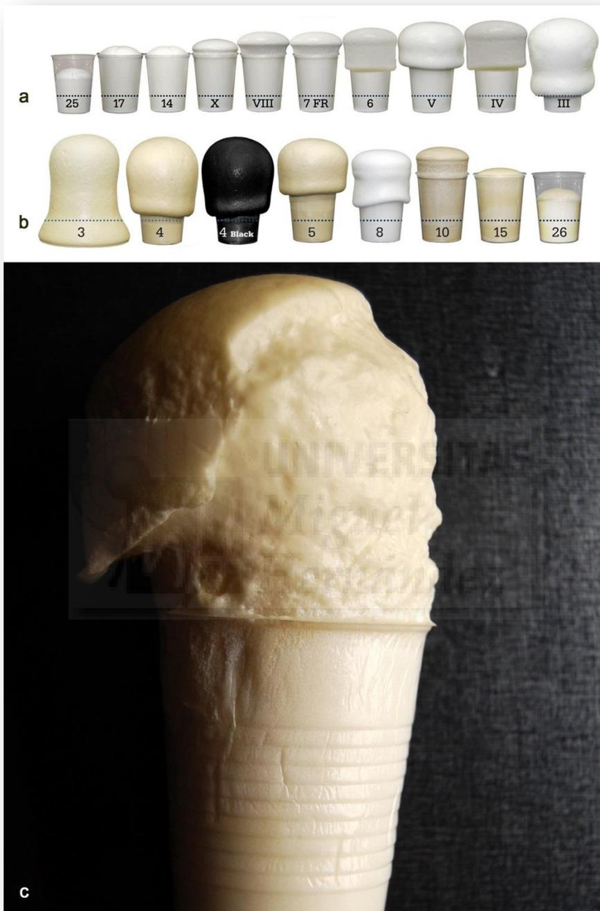
**Ilustración 156.** Espumas flexibles y rígidas de poliuretano (a y b) con diferentes expansiones, en un ratio de  $\frac{1}{4}$  de litro de capacidad (250 ml. de producto mezclado y depositado en un recipiente de un litro). Detalle del registro y expansión que ofrece la espuma (c).
