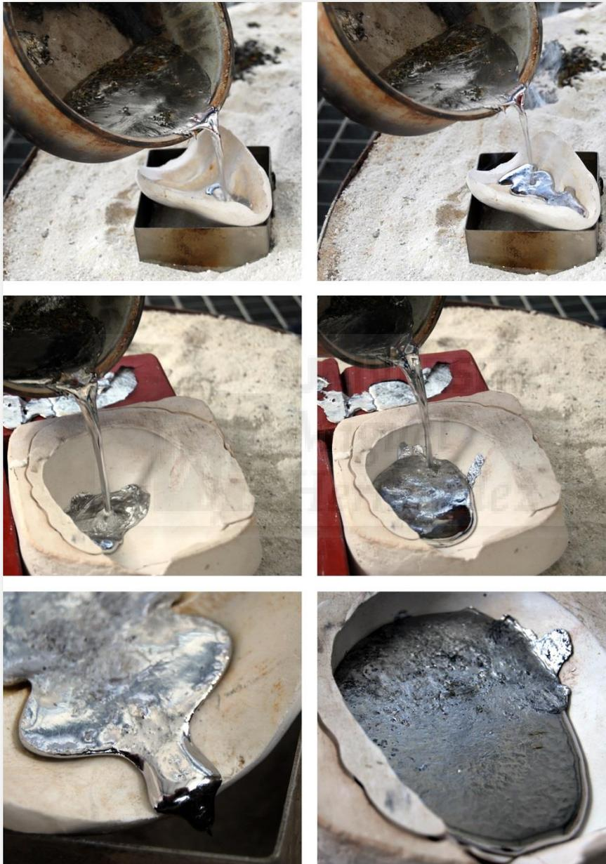
Ilustración 189. Proceso de vertido de metal en molde abierto.
