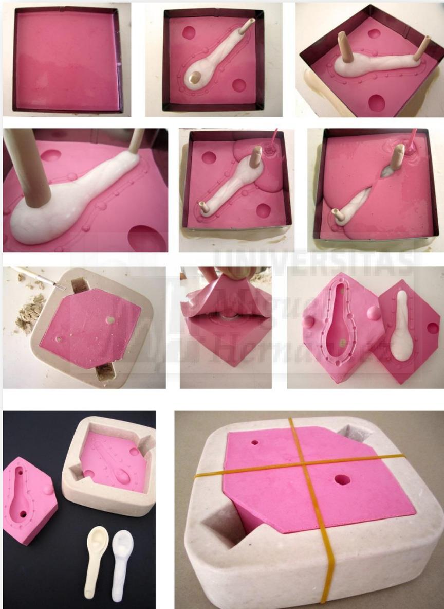
Ilustración 113. Molde reutilizable flexible de dos fragmentos por caja.
