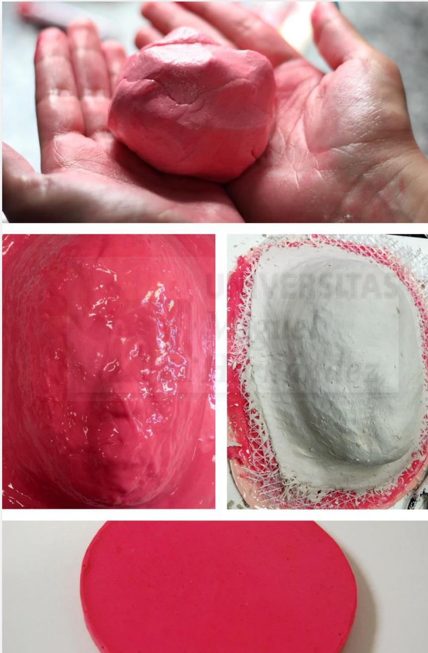
Ilustración 136. Moldeado a través de silicona en pasta.
