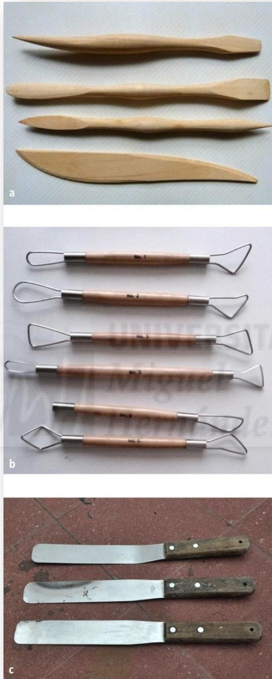
**Ilustración 122.** Los palillos de modelar (a) y los vaciadores (b) pueden resultar ser herramientas de gran ayuda para dar forma a tabiques y planos de contención. A su vez, las espátulas rectas flexibles (c) también pueden resultar ser una herramienta de gran utilidad para aplicar el yeso de forma más controlada y precisa.
