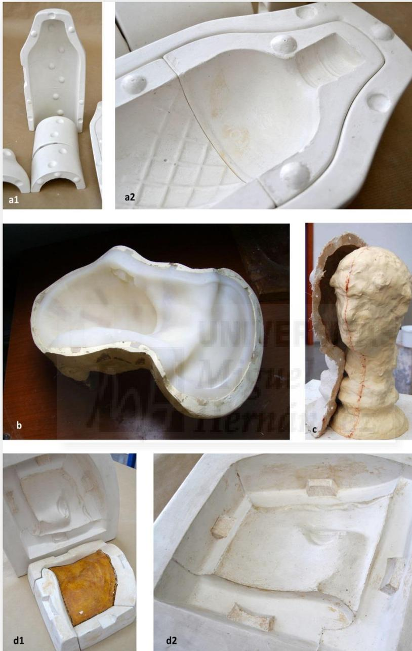
**Ilustración 79.** Tanto si el número de taceles que constituyen el molde es elevado (a1 y a2), como si el calote es inestable o presenta una gran extensión (b y c), será necesario realizar un contramolde llamado “madre” para acogerlos tridimensionalmente de forma ordenada. En las últimas dos imágenes (d1 y d2) podemos observar como la zona central del contramolde contiene parte del registro, funcionando como soporte y pieza al mismo tiempo, lo que se denomina como “madre-forma”.
