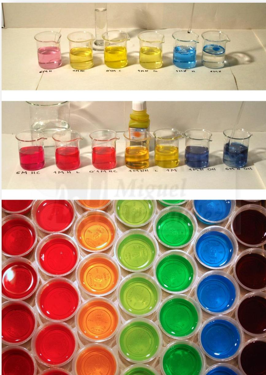
Ilustración 146. Muestras de color de resina de poliéster con diferentes tintes.
