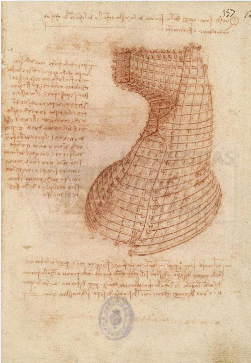
**Ilustración 18.** Estudio y diseño del refuerzo metálico ideado para fundir (solamente) la cabeza del caballo para el monumento ecuestre *Sforza a mano* de Leonardo da Vinci.
