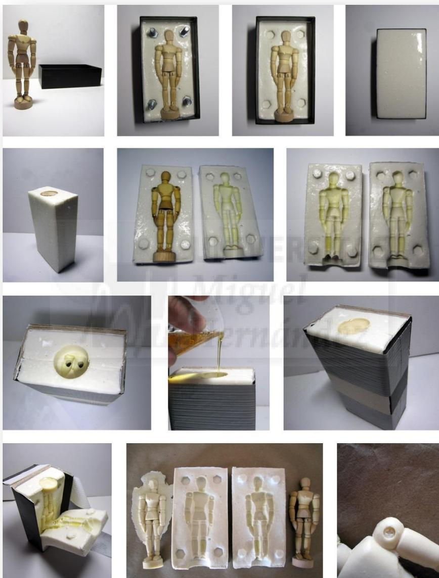
Ilustración 102. Molde desechable flexible de dos fragmentos por caja.
