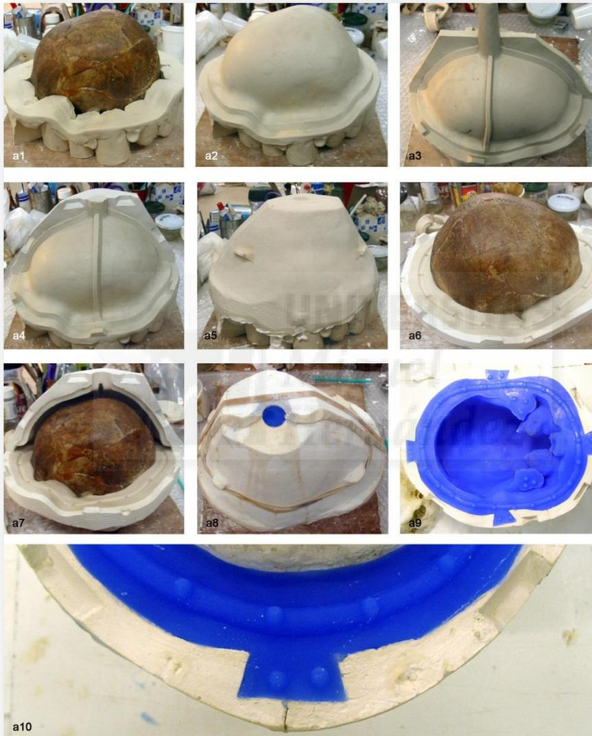
**Ilustración 91.** La aplicación por señuelo, es idónea para controlar la cantidad exacta de material y realizar moldes equilibrados en su espesor. El señuelo en sí mismo sería la capa de materia temporal que disponemos sobre el modelo (a2 y a3), que al cubrirla con un material rígido y desprender después el señuelo, nos deja el espacio (a7) que luego será materializado en materia flexible (a8 y a9) con un ajuste perfecto (a10).
