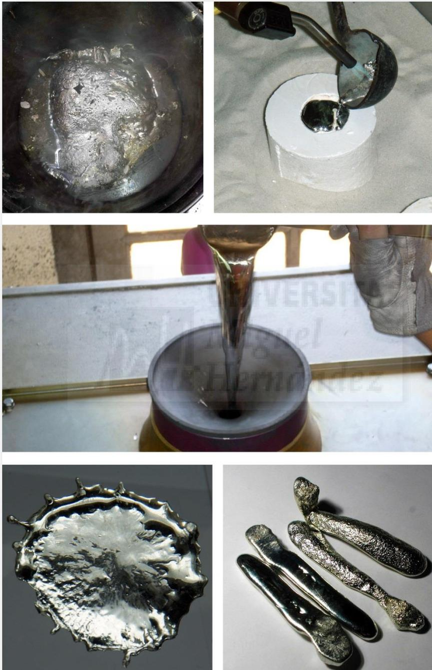
Ilustración 187. Vaciado en molde por llenado. Muestras de metal solidificado.
