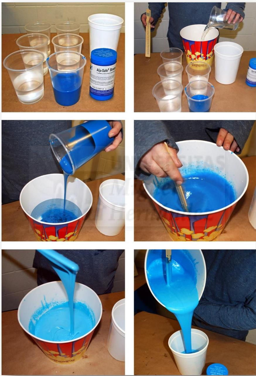
Ilustración 169. Proceso de elaboración de mezcla de alginato líquido.
