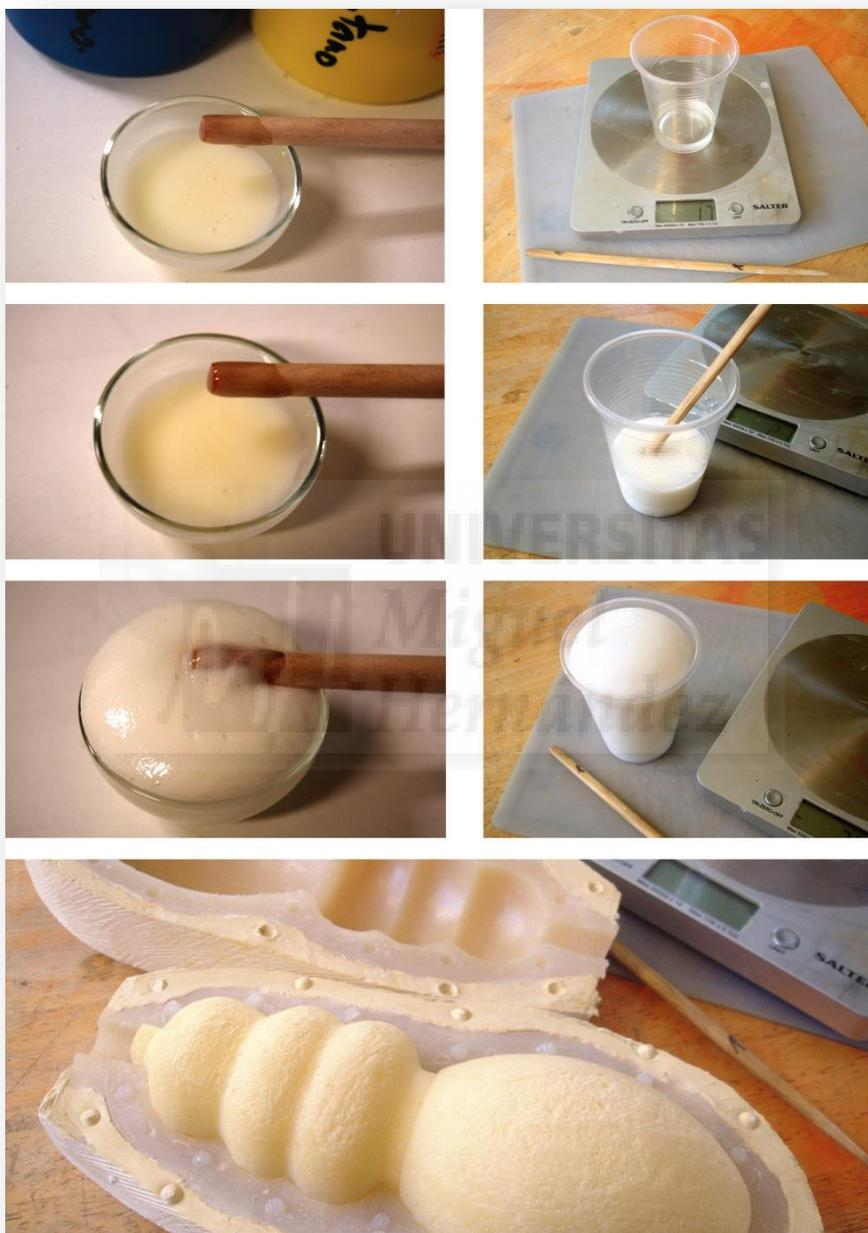
Ilustración 158. Proceso de espuma flexible de poliuretano.
