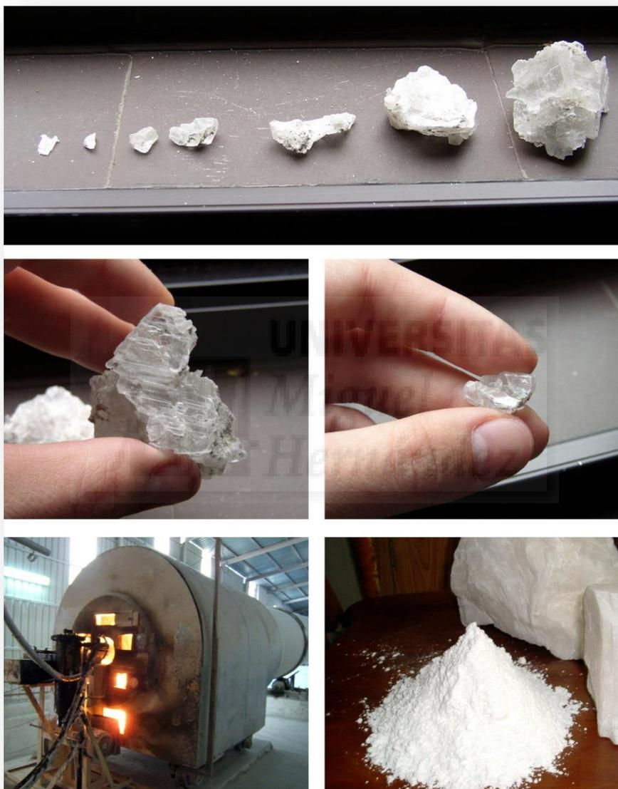
**Ilustración 175.** Muestras de fragmentos de piedra de aljez, cocción en horno y aspecto final del producto de yeso.
