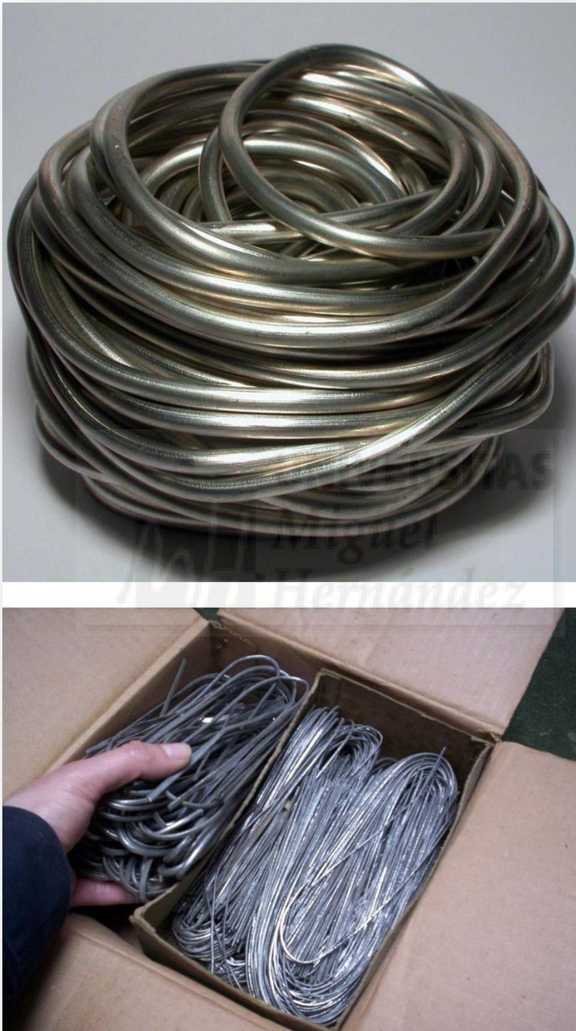
Ilustración 185. Metal en hilo o varilla. (Estaño y plomo)
