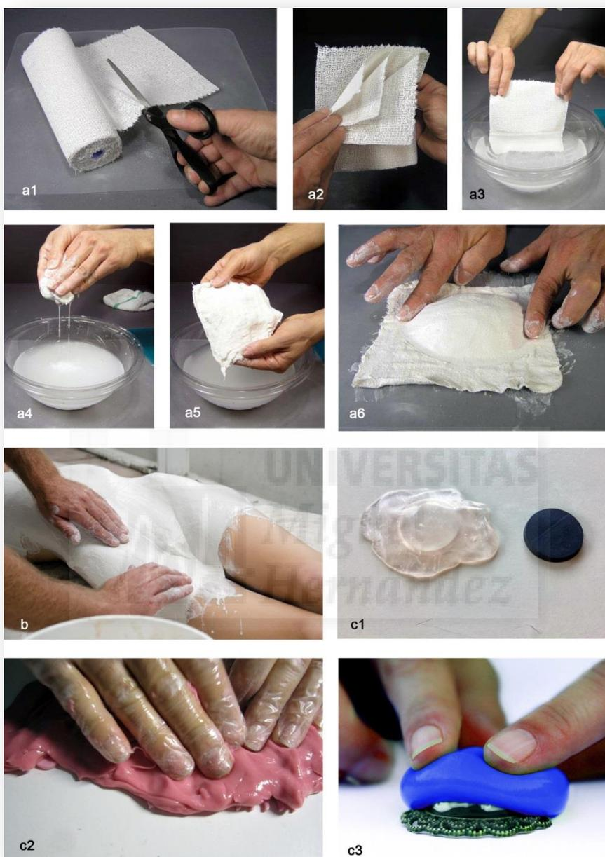
**Ilustración 89.** Una manera sencilla de realizar un molde por apretón es mediante vendas de escayola, (a1-a6), las cuales nos permiten aplicarlas sobre nuestro modelo cómodamente (b). Otros sistemas de apretón pertenecen a materiales flexibles, caracterizados por masas o masillas que aplicamos presionando sobre la superficie del modelo (c1, c2 y c3).
