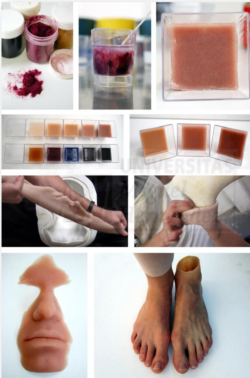
Ilustración 140. Silicona imitación piel humana. Complemento de fibras y mezcla con pigmento. Muestras de tonalidad. Ejemplo de flexibilidad en reproducción y membrana. Reproducciones de fragmentos del cuerpo (totalmente acabadas).
