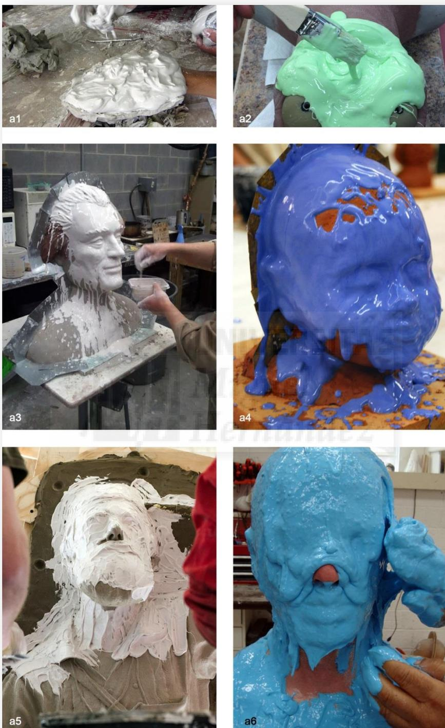
**Ilustración 87.** Diferentes sistemas de aplicación por estampado, según los materiales tanto rígidos como flexibles y complejidad del modelo.
