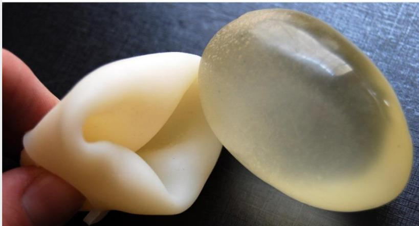
**Ilustración 131.** Desmoldeo a partir de molde por inmersión y estampado en látex.
