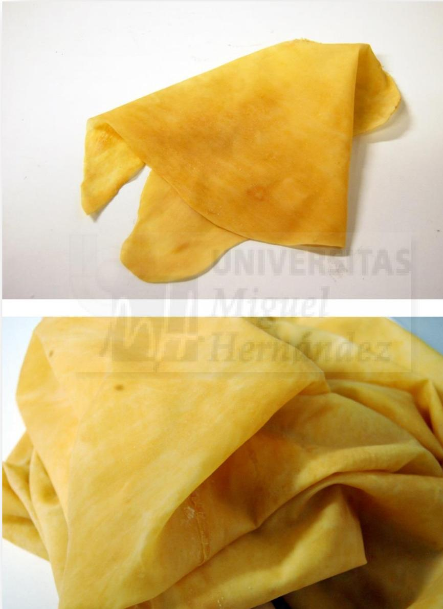
**Ilustración 128.** Lámina de látex aplicando cuatro capas.
