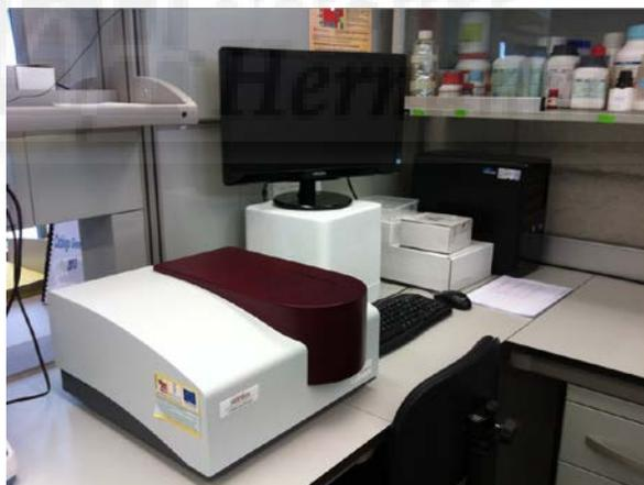
**Figura 31.** Analizador del tamaño de partícula en el rango de lo nanométrico utilizado para el presente trabajo (Brookhaven modelo 90 plus).
