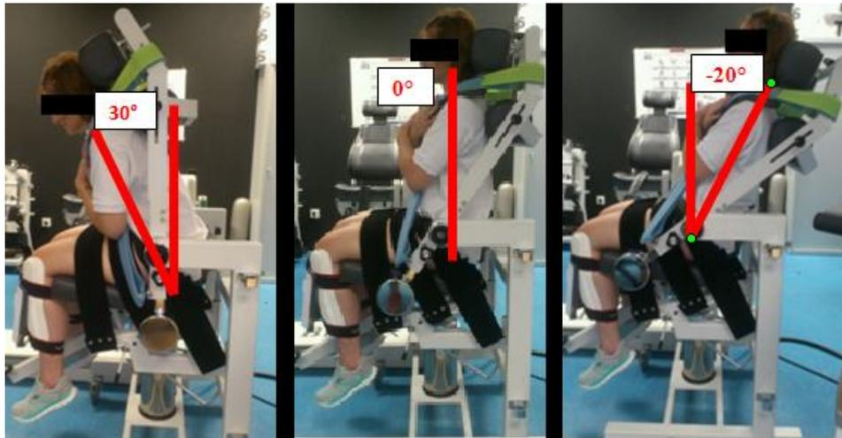
**Figura 3.** Vista lateral de una participante en el módulo de tronco del dinamómetro isocinético en las posiciones de flexión (+30°), neutra (0°) y extensión (-20°) de tronco.
