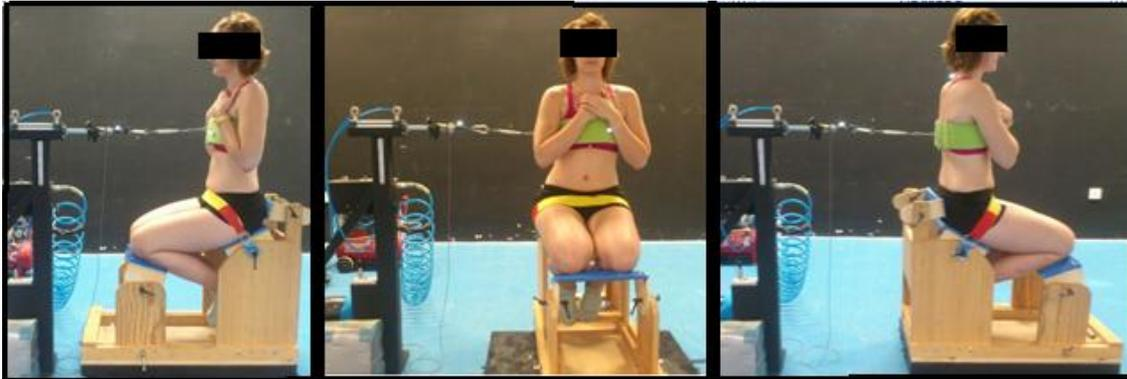
**Figura 1.** Vista del sujeto en la silla de madera y unido al mecanismo de tracción neumática durante el test de perturbaciones súbitas en sedestación. De izquierda a derecha se muestran imágenes del test en las situaciones de: tracción anterior, lateral y posterior.
