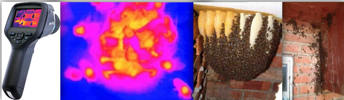
Figura 32. Se muestra una cámara de infrarrojos o térmica (sensible al calor), que detecta zonas de actividad, presencia de himenópteros, detrás de las paredes.
