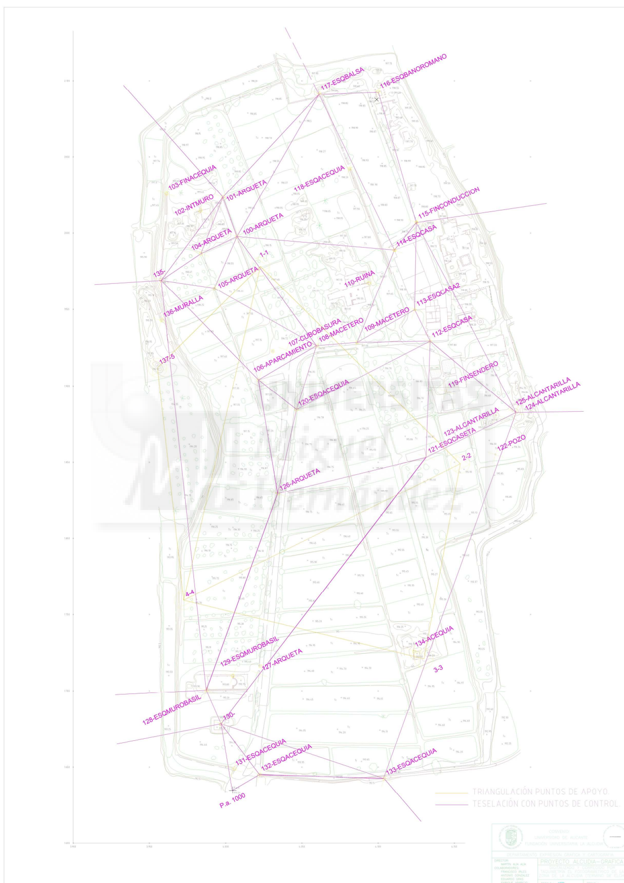
Figura 3.24: Triangulación de apoyo y teselación para corrección cartografía E:1/500 en un DIN A-0 de la Alcudia.
