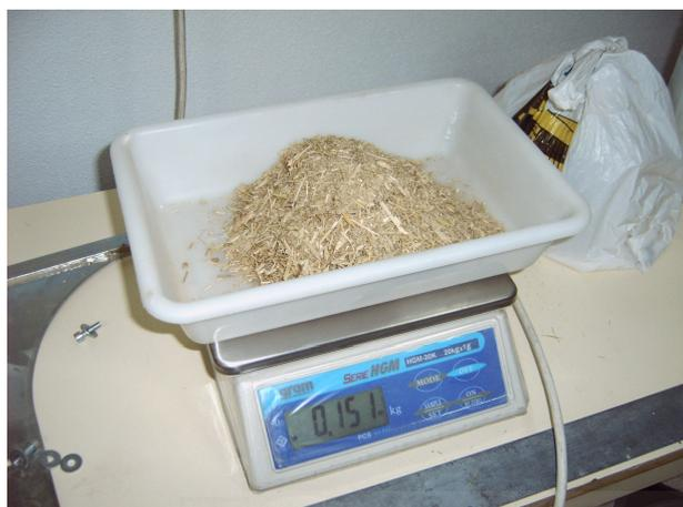
*Fig 3.22. Báscula electrónica con precisión de tres decimales en gr.*
