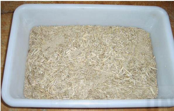
Fig 4.14. Selección de fibras sin tamiz de 4mm. Composición de mezcla.
