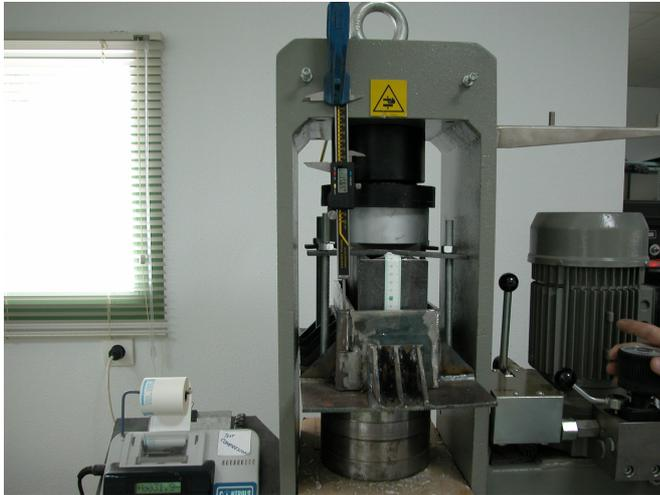
*Fig 3.24. Máquina de rotura a compresión de probetas de hormigón adaptada como prensa hidráulica de 400kg/cm<sup>2</sup>.*
