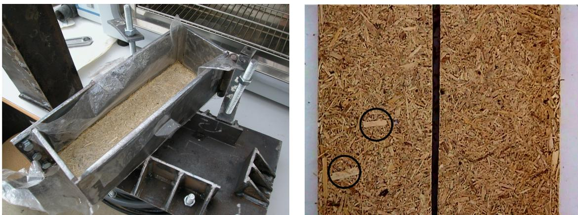
Fig 4.10,4.11. Desmoldeo del tablero que incluye el tamiz de 4mm y aspecto final de los tableros fabricados respectivamente.
