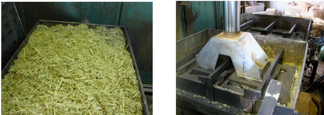
*Fig 3.15, 3.16. Conformación del tablero de caña y vástago de prensa hidráulica.*
