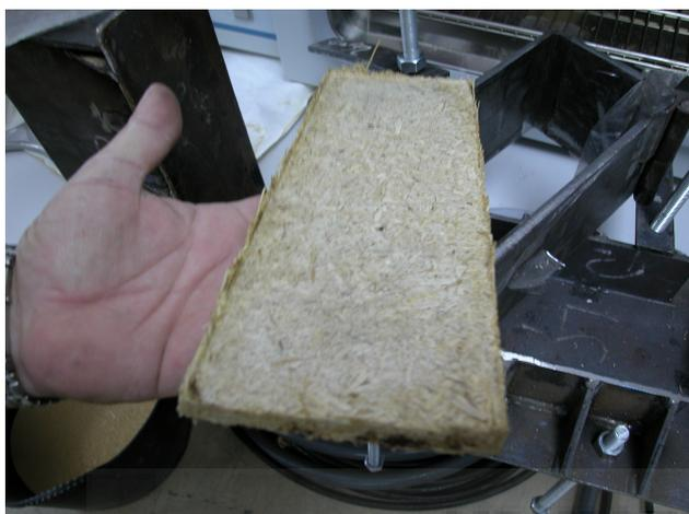
*Fig 3.26. Desmoldeo y tablero final.*
