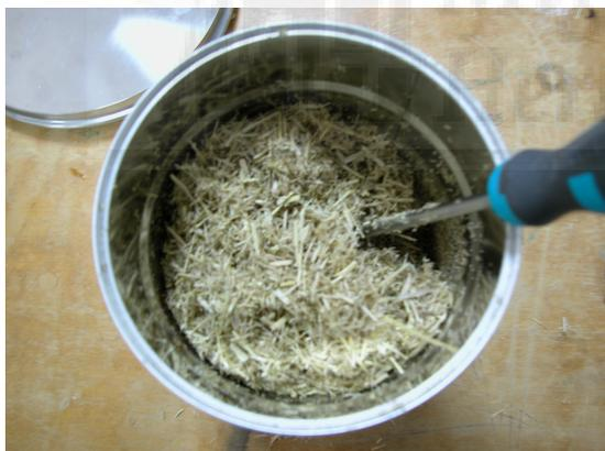
*Fig 3.18. Mezcla manual de la caña con la resina.*
