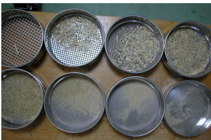
Fig 3.21. Tamices en orden decreciente de izquierda a derecha. Tamiz de 8mm, 4mm, 2mm, 1mm, 0.5mm, 0.25mm, 0.125mm, fondo.
