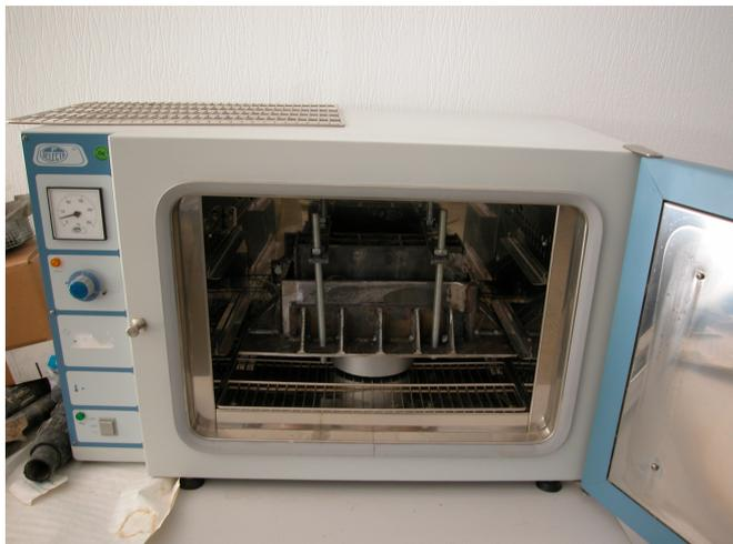
*Fig 3.25. Horno eléctrico de 250°C t<sup>a</sup> máxima, con temporizador incorporado.*
