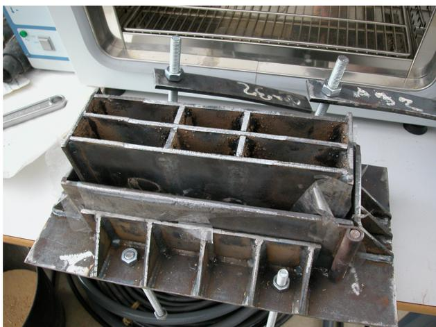
*Fig 3.23. Molde metálico para fabricación de probetas.*
