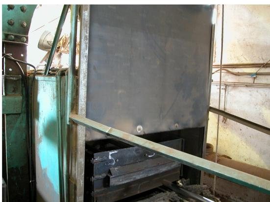
*Fig 3.17. Entrada de molde a túnel de secado.*
