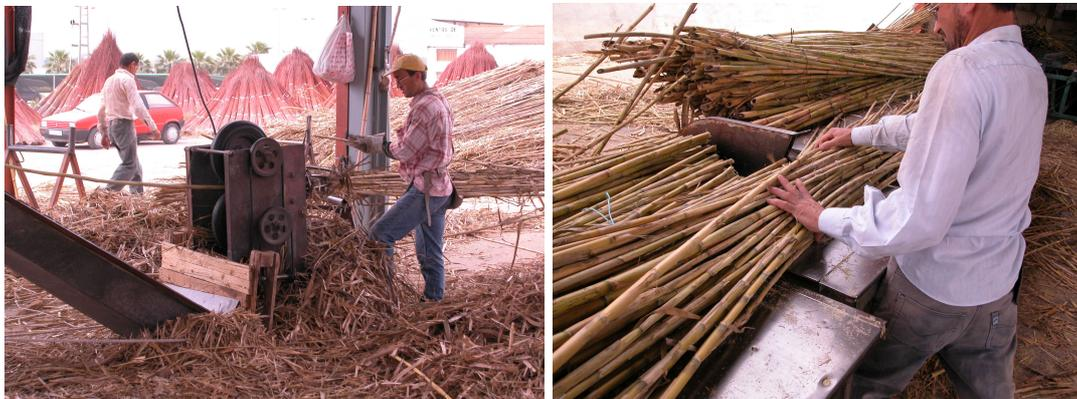
Fig 3.4,3.5. Proceso de deshojado y troceado de haces de cañas.
