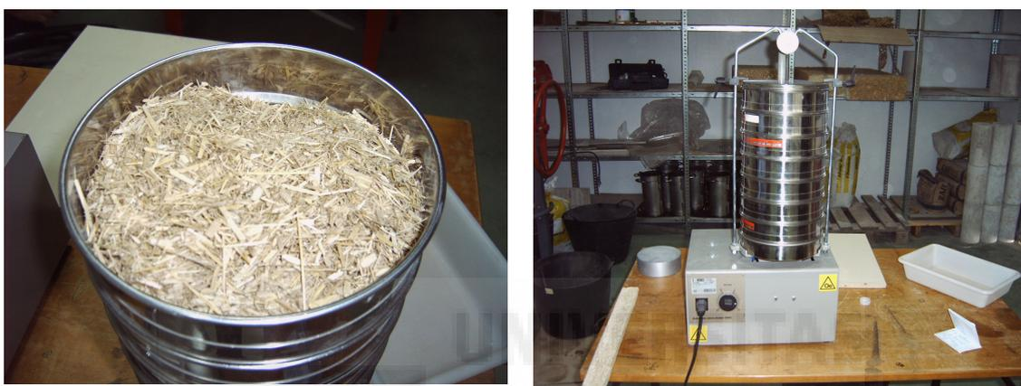
Fig 3.19, 3.20. Tamices en orden descendente con el material depositado en el tamiz superior. Máquina de vibración para tamizar las fibras de caña.
