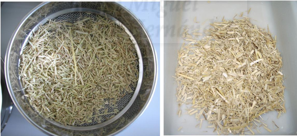
*Fig 4.8, 4.9. Material previo al tamizado y resultado del Tamiz de 4mm, respectivamente.*
