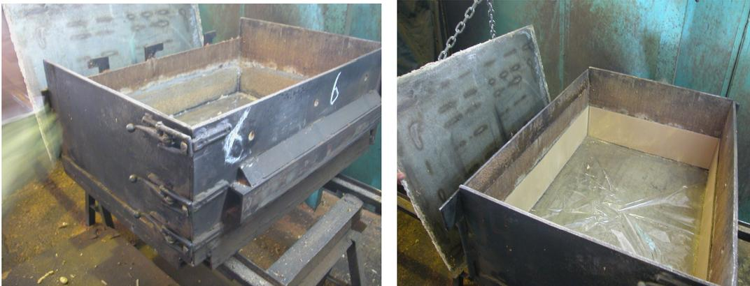
Fig 3.11, 3.12. Preparación de Moldes.
