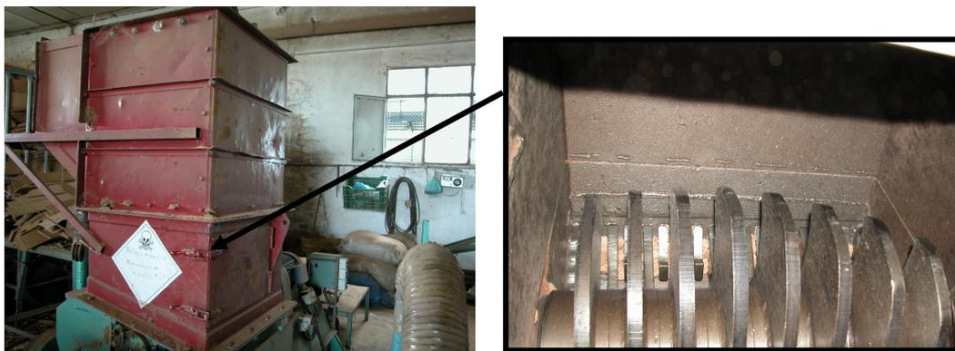
Fig 3.6, 3.7. Desfibradora y martillos o mazas de desfibrado, respectivamente.
