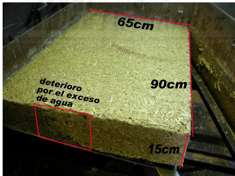
Fig 4.2. Desmoldeo del tablero fabricado en bruto.
