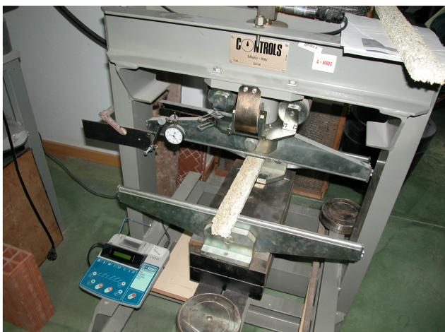
*Fig 3.27. Máquina para ensayo a flexión con precisión +/-1 kgf.*
