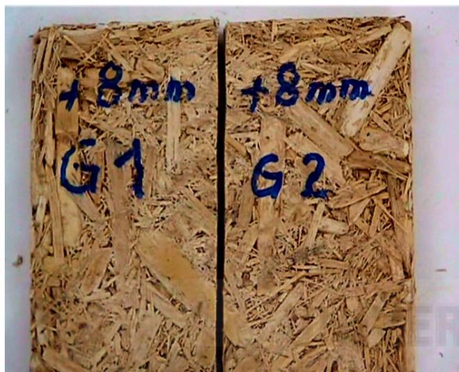
Fig 4.6. Tablero con tamiz de 8mm.Resultado final.
