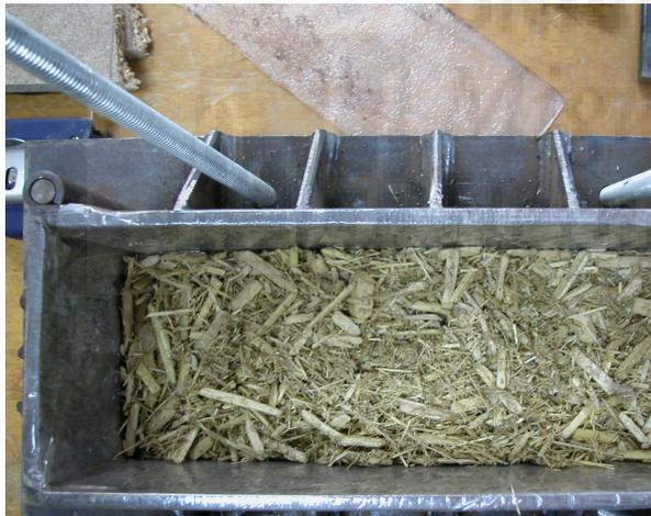
Fig 4.5. Tablero con tamiz de 8mm. Interior del molde antes de cerrar.
