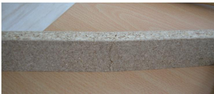
Fig 4.18. Tablero de aglomerado de madera ensayado.
