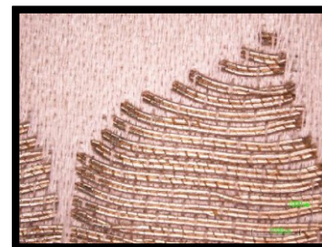
Ilustración 10: Imágenes del tejido e hilos metálicos con microscopio estereoscópico
