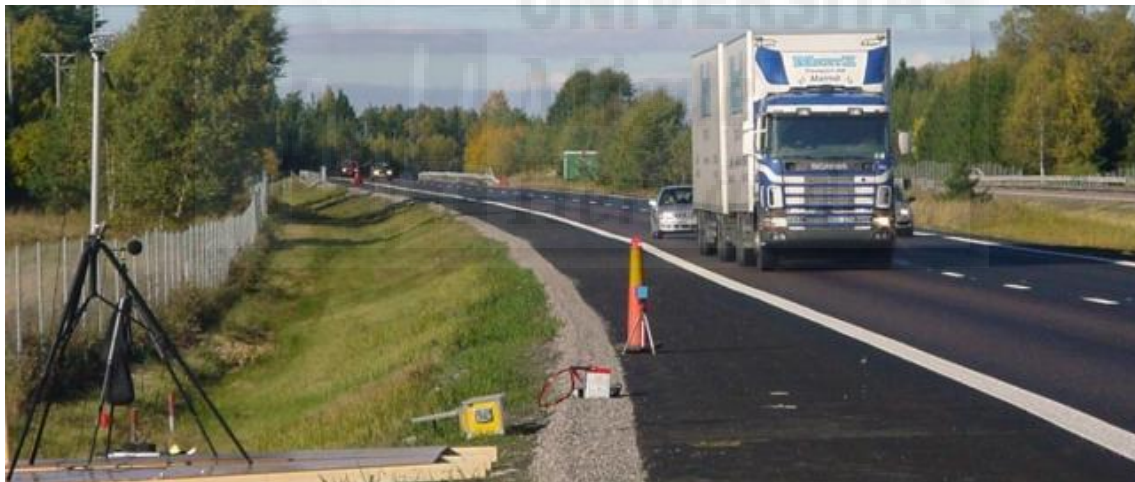
Figura 14. Esquematización del ensayo Statistical Pass-By
