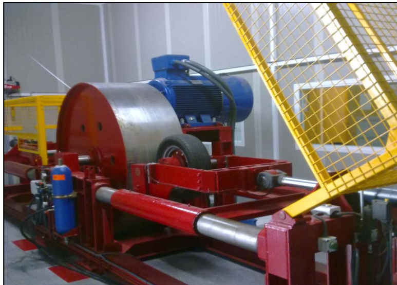
Figura 16. Máquina de ensayos de neumáticos empleada en el Método Drum
