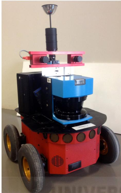
**Figura 3.21:** Imagen del robot P3-AT utilizado para la captura de imágenes.
