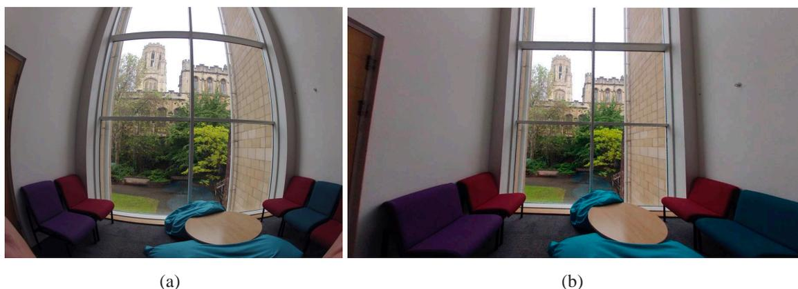
**Figura 3.20:** (a) Imagen capturada con cámara GoPro Hero y (b) imagen con distorsión corregida.
