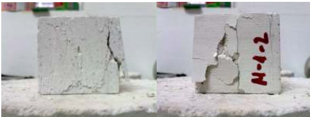
Fotografía 66: Estado de las probetas tras ser sometidas al ensayo de compresión. (Fuente: Elaboración Propia, 2010)
