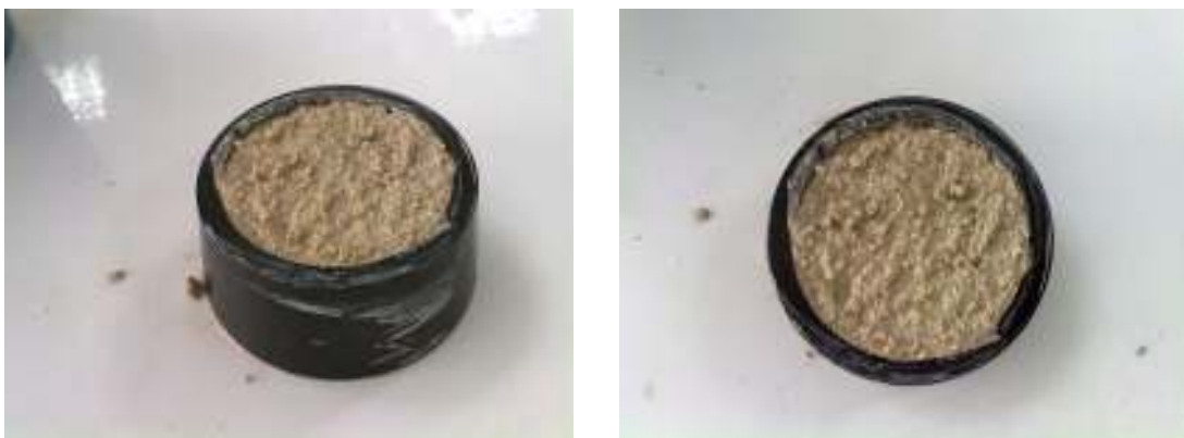
Fotografía 63: Molde relleno de mortero. (Fuente: Elaboración Propia).
