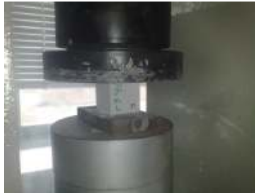
Fotografía 65: Ensayo de compresión de una probeta en la prensa de la máquina de compresión. (Fuente: Elaboración Propia, 2010)
