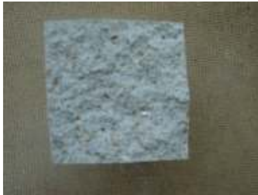
Fotografía 60: Probeta de yeso moreno aditivada y con vermiculita laminada. (Fuente: Elaboración Propia)
