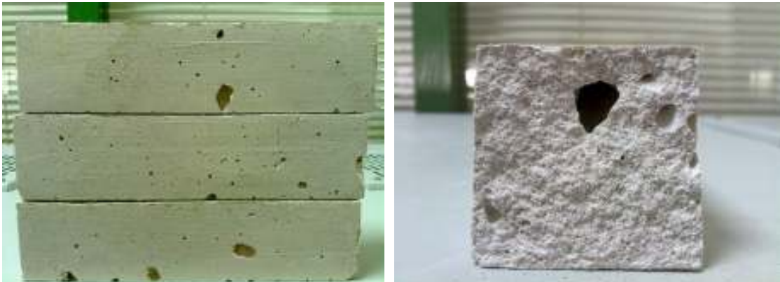
Fotografía 57: Coquera (Burbuja de aire junto a la pared del molde). Fotografía 41: Burbuja de aire dentro de la probeta. Defecto en la fabricación de las probetas de yeso. (Fuente: Elaboración Propia)
