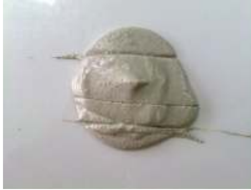
Fotografía 67: Galleta de pasta de yeso con hendiduras hechas por el Método del cuchillo. (Fuente: Elaboración Propia)
